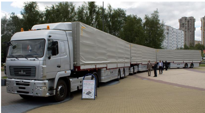
Рис. 5. Многозвенный автопоезд, разработанный Объединенным институтом машиностроения НАН Беларуси совместно с ОАО «МАЗ»
