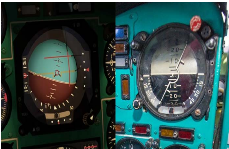
Рис.2. Слева – индикация крена на разбившемся самолёте. Справа – индикация крена, к которой привык командир
