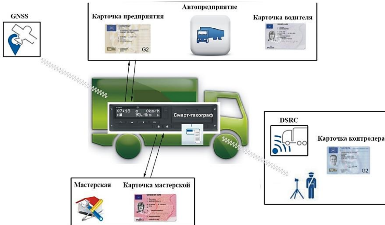
Рис. 1. Функциональная схема системы смарт-тахографа
