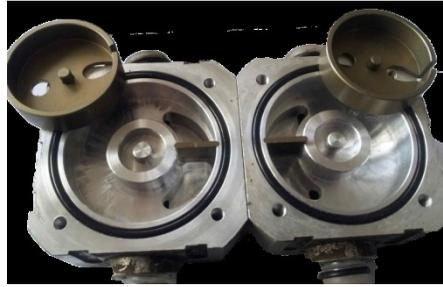
*Рис. 3. Вскрытие расходомера Eurosens Delta для очистки*
