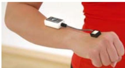
Рис. 3. Акселерометр DTS 3D (Noraxon Inc., U.S.A.)
